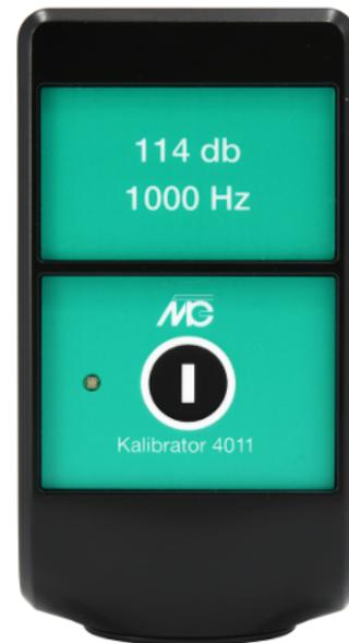
Der akustische Kalibrator 4011 ist eine akustische Schallquelle zum Kalibrieren und Überprüfen von Schallpegelmessgeräten. Er entspricht den Anforderungen an Klasse 1-Kalibratoren gemäß IEC 60942 und kann einen Schalldruckpegel von 114 dB mit einer Frequenz von 1000 Hz erzeugen, womit die Kalibrierung von Schallpegelmessgeräten überprüft werden kann.
