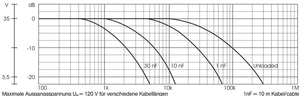
Maximale Ausgangsspannung  $U_B = 120$  V für verschiedene Kabellängen
